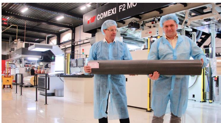
Foto: Weinand van Kesteren en Jan Bijl (Apex account manager voor VIV) met een GTT raster sleeve, een onmisbaar element bij het bereiken van de voor het Smart Digital Flexo-concept noodzakelijke consistente inktoverdracht.
